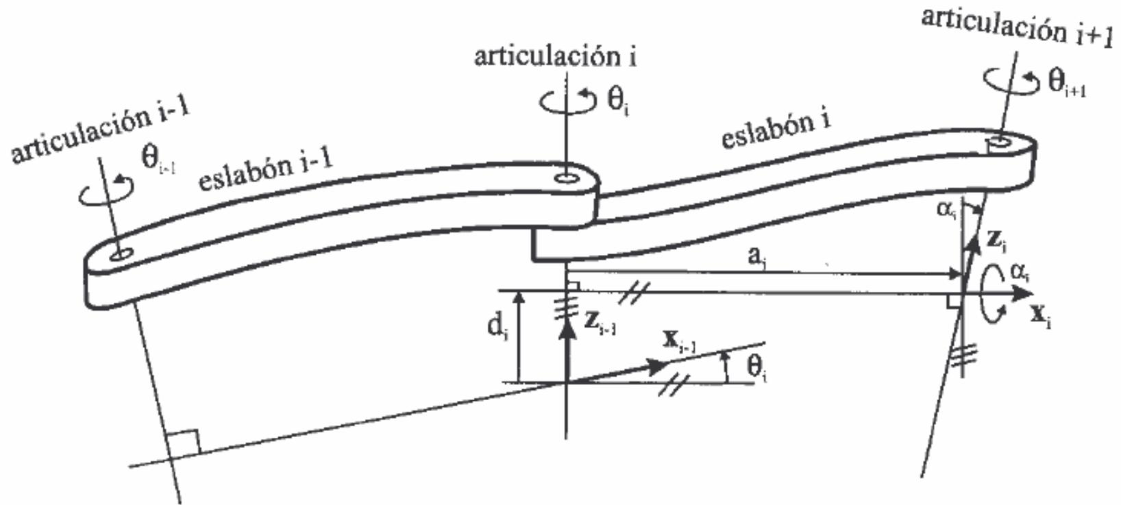
$\theta_i$  es el ángulo que forman los ejes  $X_{i-1}$  y  $X_i$  medido en un plano perpendicular al eje  $Z_{i-1}$ , utilizando la regla de la mano derecha. Se trata de un parámetro variable en articulaciones giratorias.
