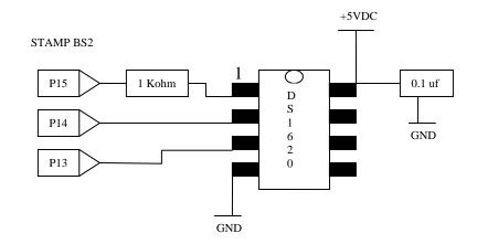
P15 serial SPI data in and out TO 1kohm resistor TO DS1620 PIN 1 (DQ) P14 serial data clock TO DS1620 PIN 2 (CLK) P13 chip select TO DS1620 PIN 3 (RST) DS1620 PIN4 (GND) TO Vss (GND) DS1620 PIN8 (Vdd) TO Vdd (+5VDC) DS1620 PIN8 (Vdd) TO 0.1uf polarized cap TO Vss (GND) Rev 5/28/07
